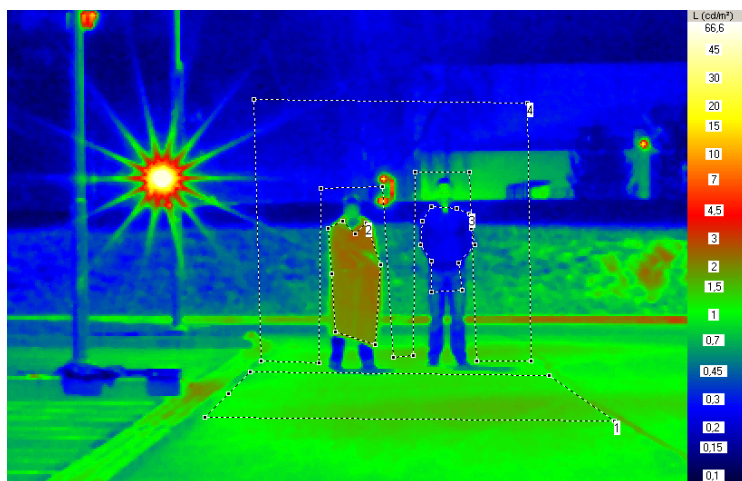
Obr. 2 Měření jasů v zorném poli řidiče při současném použití veřejného a automobilového osvětlení
