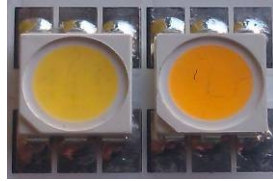
• obrázok 2. Detail LED čipov pre tvorbu biodynamického osvetlenia. [1]
