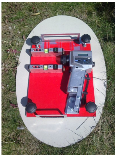
Obr.4 Stand s jasomerom pre meranie jasov povrchu vozovky
