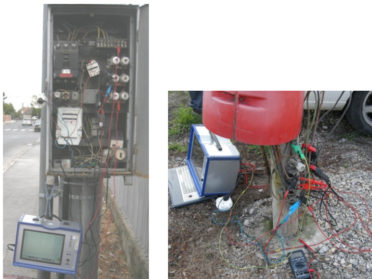
• Obr. 2 Meranie v RVO (vľavo), meranie na svorkovnici stožiaru (vpravo)
