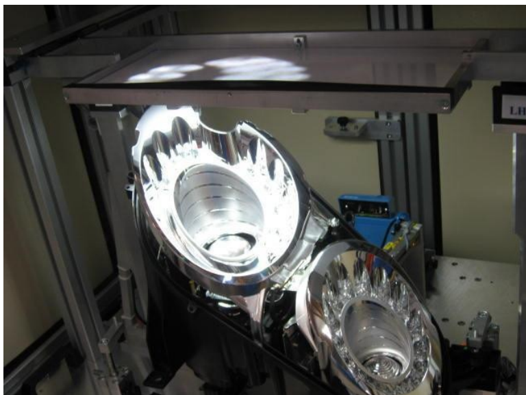
Fotometrický tester na konci výrobní linky světlometu.
