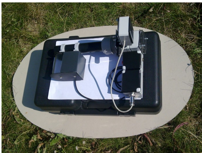
Obr. 7 VF tester – jasomer osadený (experimentálnym) snímačom priestorových jasov
